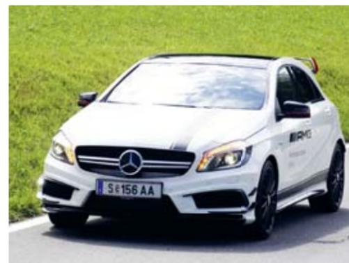
Sportprogramm „S“ liegen auf ähnlich sportlichem Niveau wie die des Supersportwagens SLS AMG GT. Im Modus „C“ (Controlled Efficiency) unterstützen weich ausgelegte Getriebe- und Motorlinien eine verbrauchsbetonte Fahrweise. Außerdem ist im „C“-Modus die ECO Start-Stopp-Funktion aktiviert. Das AMG-Sportfahrwerk mit spezifisch abgestimmten Feder-Dämpfer-Elementen und stärker dimensionierten Stabilisatoren sorgt für hohe Querschleunigung und reduziert die Wankneigung in schnell-
